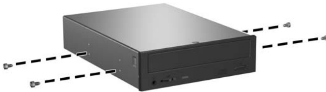
Abbildung 2-18 Installieren von Führungsschrauben (am optischen Laufwerk)
