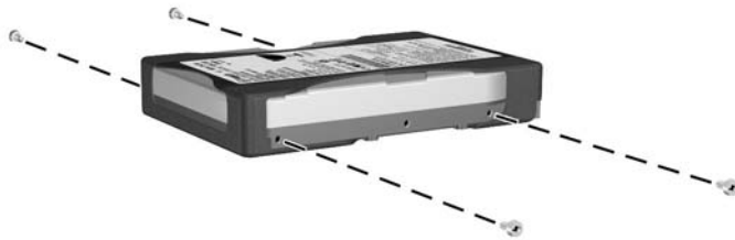
Abbildung 2-26 Anbringen der Festplattenführungsschrauben
