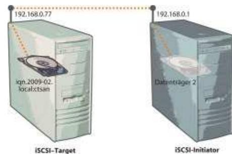
Im iSCSI-Jargon nennt man den Server, der den Netwerkspeicher anbietet, "Target". Der PC, der die virtuelle Festplatte einbindet, heißt "Initiator".
