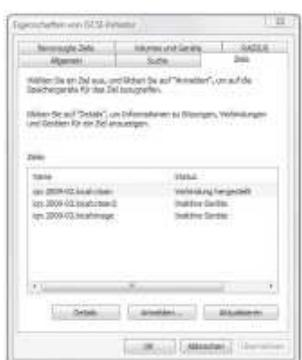
Vista hat bereits den iSCSI-Initiator an Bord, der die Verbindung zur Netzwerk-Festplatte herstellt. Für XP bietet Microsoft die Komponente zum Download an.
